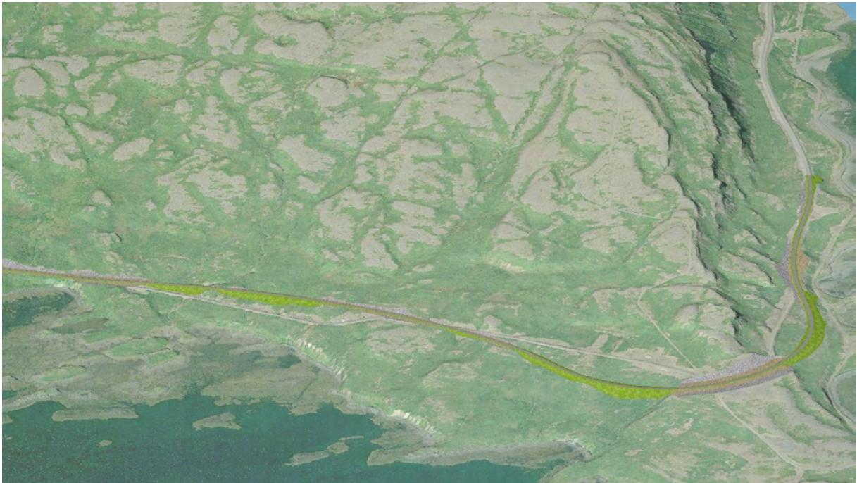
Þrívíddarmynd 1. Veglína á svæðum I og II (stöðvar -1600 að 1500). Grænt=fylling, grátt yrjött=skering og brúnt yrjött= landmótunarsvæði. Myndvinnsla Halldór Sv. Hauksson.
