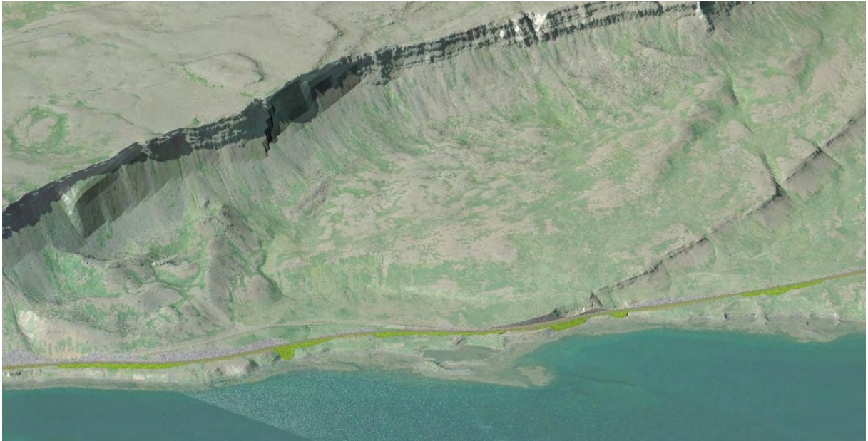
Þrívíddarmynd 12. Vesturhlíð Kerlingarfjarðar á milli stöðva 4400-6900. Grænt= fylling, grátt= skering, brúnt yrgótt= landmótunarsvæði. Myndvinnsla: Halldór Sv. Hauksson.
