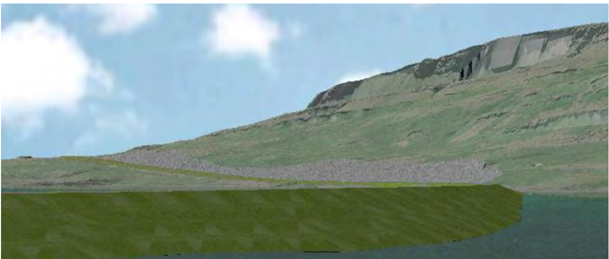
Þrívíddarmynd 11. Ytri þverun Mjóafjarðar, leið A (veglína h660-008), og skeringarsvæði innan við Borgarnes. Grænt= fylling, grátt= skering, brúnt yrrótt= landmótunarsvæði. Myndvinnsla: Halldór Sv. Hauksson.
