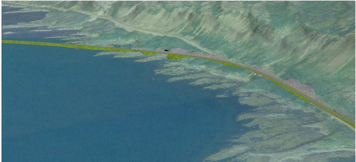
Þrívíddarmynd 24. Austari hluti þverunnar um Kjálkafjörð. Grænt= fylling, grátt= skering. Myndvinnsla: Halldór Sv. Hauksson.
