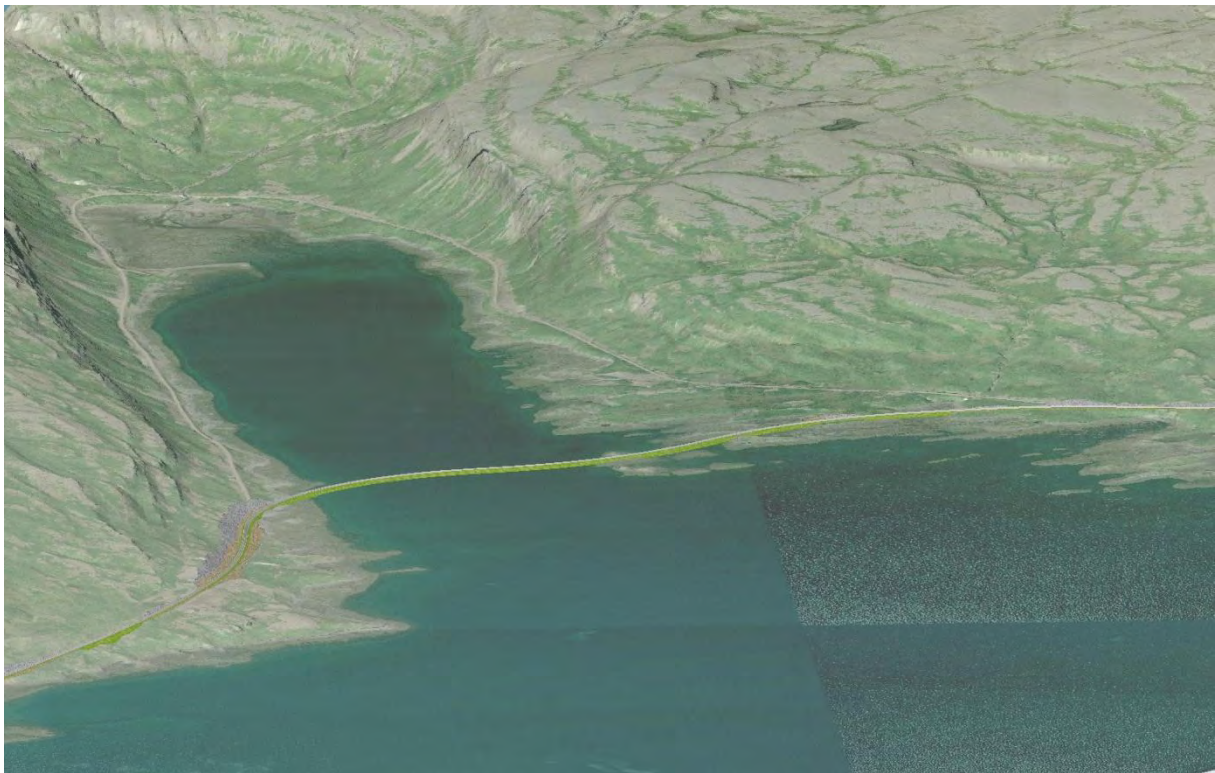
Þrívíddarmynd 5. Leið A (veglína h660-008) um Mjóafjörð. Grænt=fylling, grátt yrjótt=skering og brúnt yrjótt=landmótunarsvæði. Myndvinnsla Halldór Sv. Hauksson.
