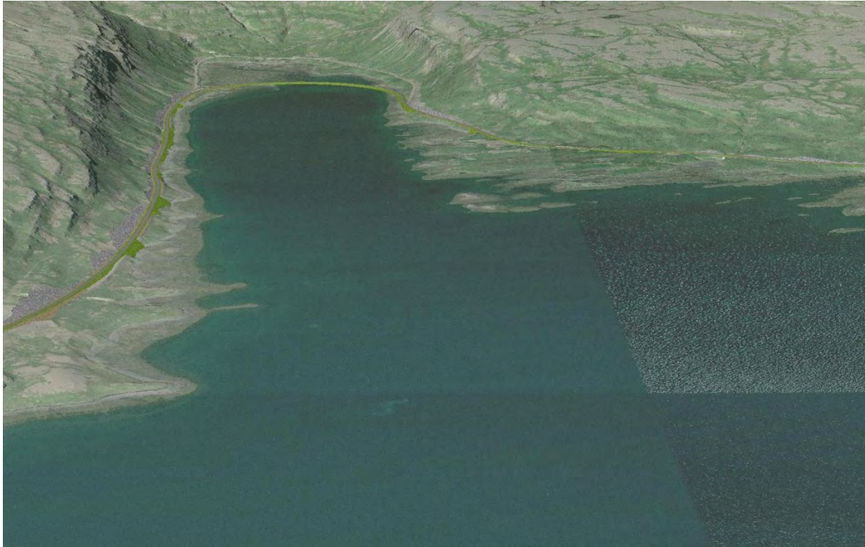
Þrívíddarmynd 9. Leið B um Mjóafjörð (innri þverun). Grænt=fylling, grátt yrjótt=skeringar og brúnt yrjótt=landmótunarsvæði. Myndvinnsla Halldór Sv. Hauksson.
